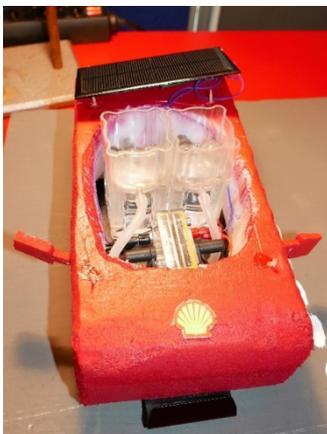
Außerdem stellte unser Team ein Modell eines „Brennstoffzellen-Solar-Hybridautos“ vor. Dieses „Auto von morgen“ enthält anstelle von Benzinmotoren einen Wasserstoff-Antrieb. Die Basis dieser „Motoren“ sind Wasserstoff-Sauerstoff-Brennstoffzellen, die durch Zufuhr von Wasserstoff und Sauerstoff als Abfallprodukt nur Wasser produzieren.
